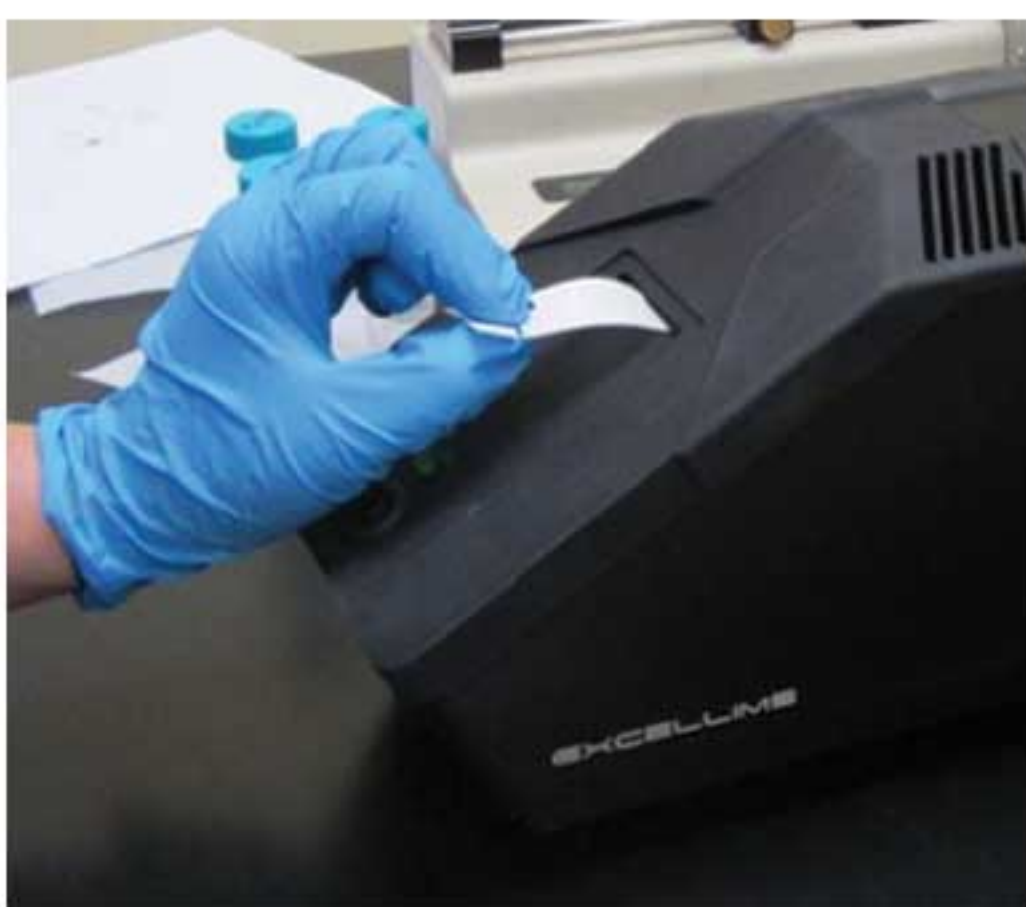
热解析电晕放电离子源测定固体样品，配有气体进样口
