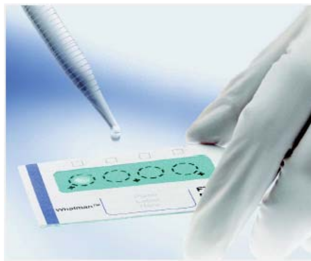
图1. 通过指示型FTA DMPK卡能够快速简便地采集无色生物样本。
